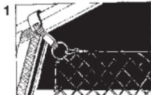
La parte alta della rete può essere fissata alla canalina del tetto usando i ganci in dotazione. Fare passare il cavetto elastico attraverso le maglie della rete, ed agganciarlo ai due anelli presenti alle due estremità.
